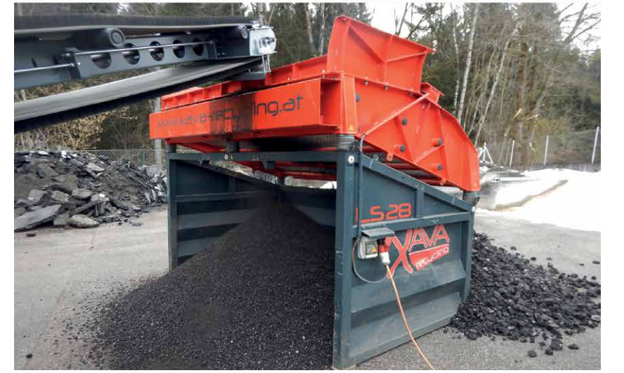
Einwandfreie Durchsatzleistung & ausgezeichnete Siebergebnisse auch bei Beschickung über eine Brechanlage
