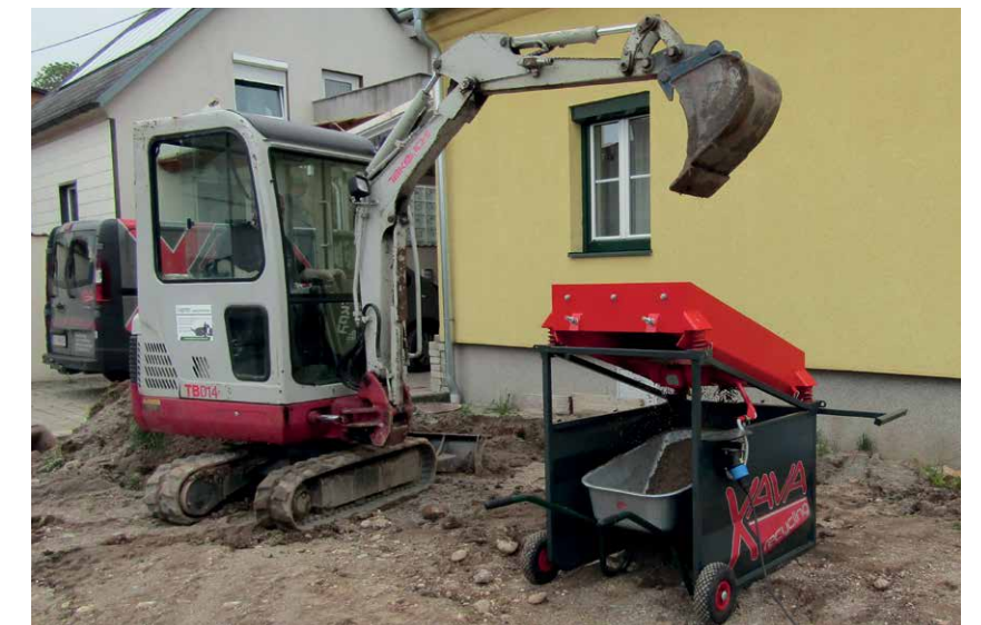
Eine Beschickung mit Bagger ist möglich, aber kein Muss. Diese Kompaktsiebmaschine kann auch mit einer Schaufel per Hand bestückt werden.
