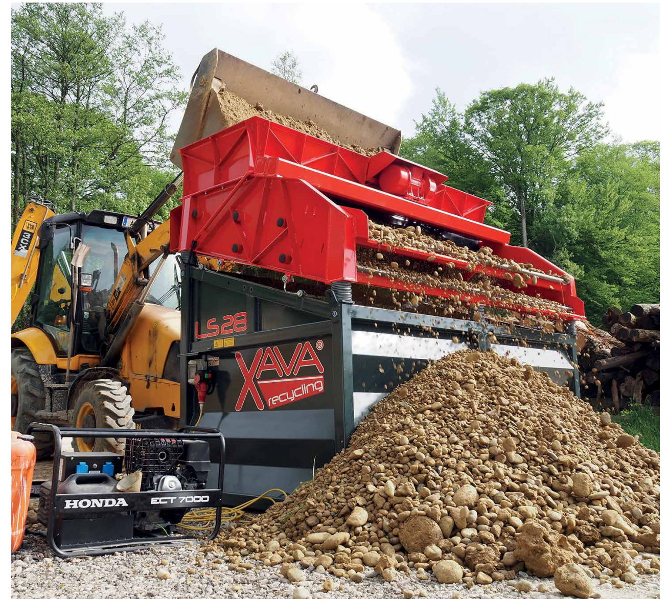
Saubere Separierung von Steinen und feiner Erde zum Einsatz im neuen Erdmännchengehege des Tierparks Haag (Niederösterreich).
