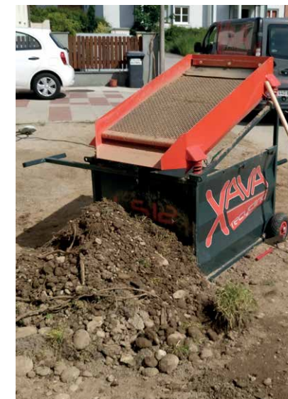
Das Sieb LS12 hat eine Siebfläche von 1040x675 mm und eine Aufstellfläche von 1100 x 800 mm
