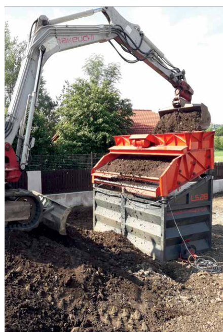
Feine Erde, abgeseibt auf 0-10mm und befreit von Wurzeln und Steinen zur ökonomischen Wiederverwendung im Gartenbau. Mit Hilfe des Rüttelsiebs LS28 konnte dieser 600m 2 Garten in 1,5 Tagen völlig neu angelegt werden.
